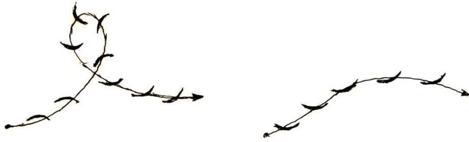
図 1.6 カワラケの凸部を上（左図）、および下（右図）にして投げた場合の飛び方（レポートの図の模写）
